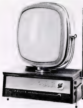
Bild 1. Predicta 4242, ein neuartiger Fernsehempfänger mit drehbar aufgesetzter extrem kurzer 53-cm-Bildröhre von Philco
