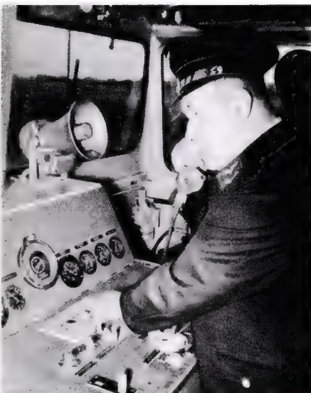
UKW-Telefon-Bediengerät und Lautsprecher von BBC im Führerstand einer Lokomotive. Sämtliche Teile sind explosionsgeschützt
